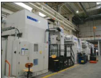
Liebherr bietet unterschiedliche Varianten von Wälzfräsmaschinen an. Zahnräder bis zu 16 Metern Durchmesser können voll automatisiert gefertigt werden.
